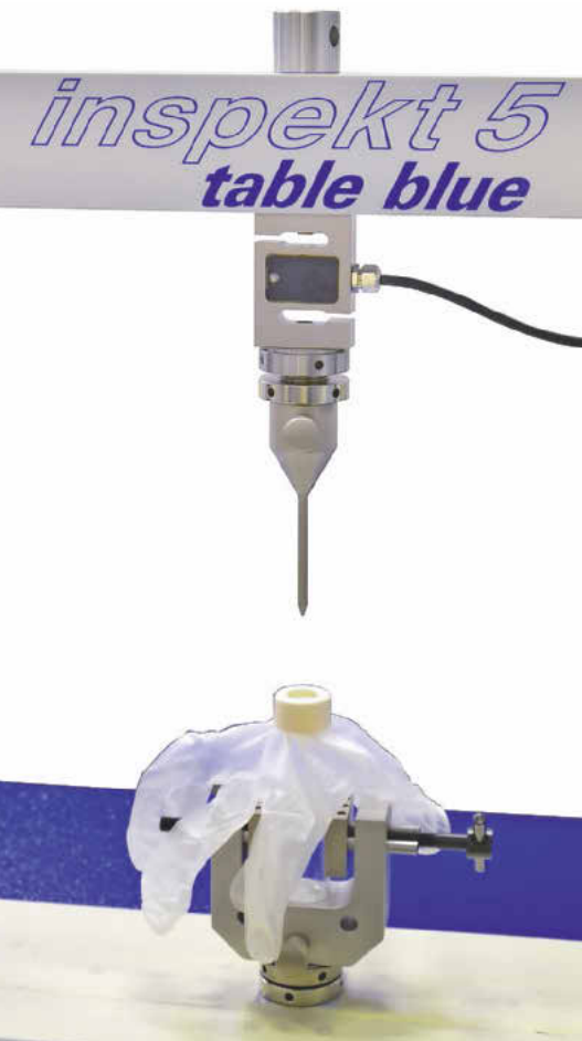
Prüfung von Schutzhandschuhen mit einer Inspekt-Universalprüfmaschine
